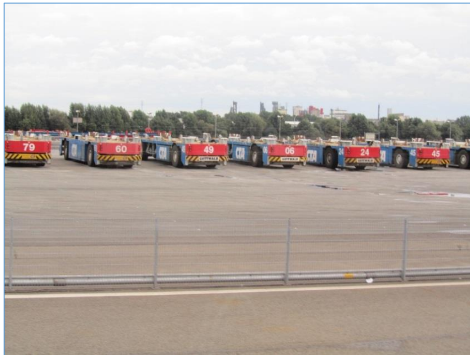
Figur 3 Automatiske transportvogne til containere - Hamburg Hafnen
