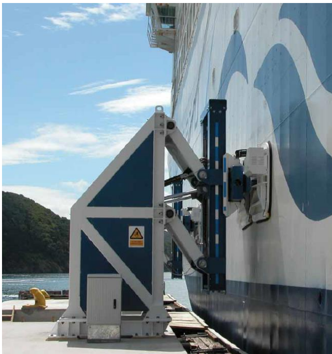
Figur 19 Automatisk fortøjningsanlæg - Vakuum - sug
